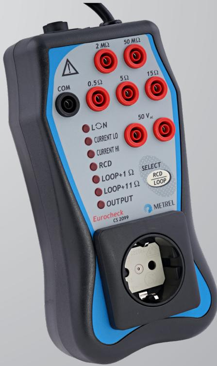
Der CS 2099 Eurocheck ist ein professioneller, multifunktionseller Feldkalibrator, der mit Installationstestern verwendet wird. Mit dem Eurocheck kann die Funktion aller Geräte von Metrel und auch die der meisten anderen Hersteller geprüft werden. Der CS 2099 Eurocheck bietet die Möglichkeit der einfachen Feldkalibrierung für die meisteingesetzten Funktionen bei der Elektroprüfung.
